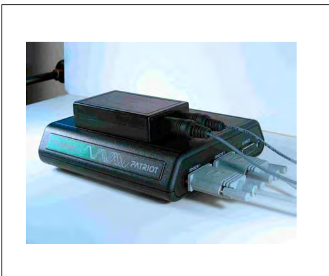
Abbildung 4: magnetisches Trackingsystem der Firma Polhemus
